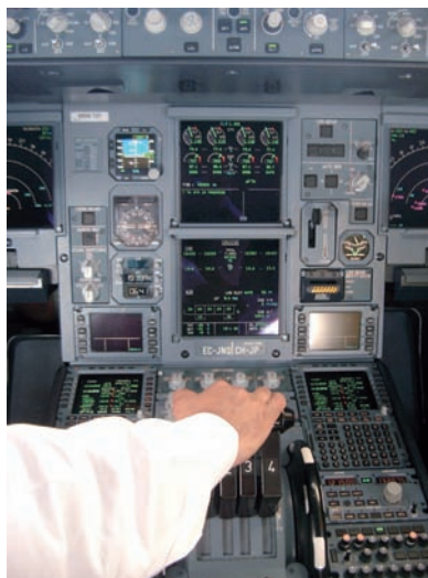
Los gases automáticos en la familia de aviones Airbus 320/330 y 340 permanecen fijos en el detent CL
